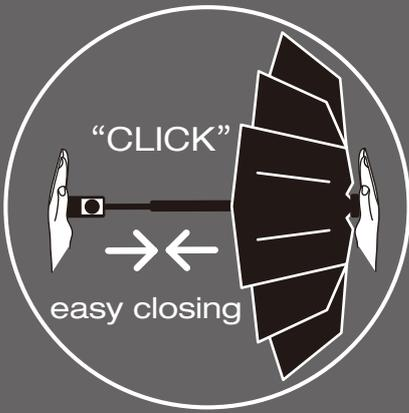
クニルプス自動開閉折りたたみ傘の一部商品には、シャフトの不意な飛び出しを防ぐ安全構造「セーフティー・システム」が採用されています。シャフトを手で押し戻すのを途中で止め手を離しても、シャフトが元の長さまで戻ることがありません。
